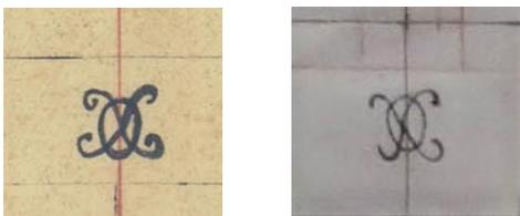
図 19 船体中央部記号 (左: 従来図面、右: 新図面)
