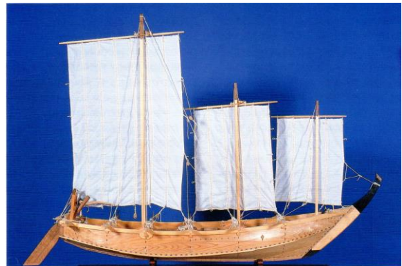
図14 杉村宗作の八丁櫓鰹釣漁船の1/10模型
